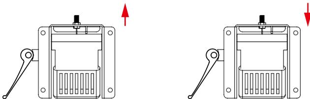
Ситуация 1. Если при нажатии на ручку газ-лифт не реагирует затяните регулировочную гайку.
