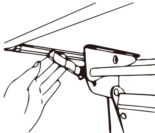
5. Отрегулируйте жесткость изменения угла наклона столешницы гайкой.
