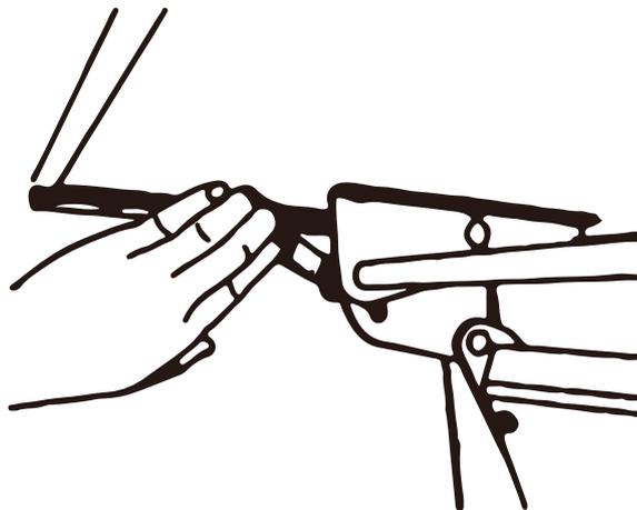
4. Отрегулируйте необходимый угол наклона столешницы и заблокируйте ручку фиксации угла наклона.
