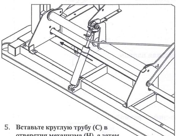
5. Вставьте круглую трубу (C) в отверстия механизма (H), а затем в ось левой ноги (F).
