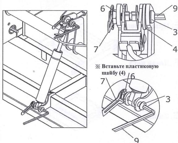
4. Крепко прикрутите газ-лифт к механизму (H) и L-образной столешнице (A), используя шестигранник-отвертку (9), ключ (7), болты (3) и гайки (6), как показано на рисунках.
