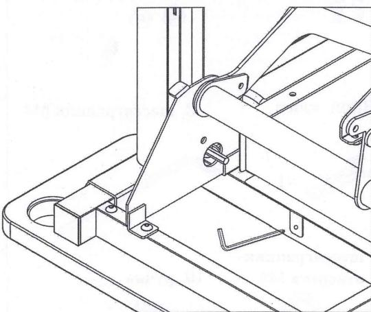
3. С помощью шестигранника-отвертки M5 (9) и винтов (5) закрепите переднюю панель (1) на L-образной столешнице (A).
