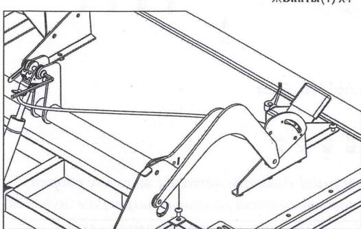
4-1. Провод должен проходить между механизмом (H) и основной столешницей (B). Ручку необходимо закрепить на столешнице (B) с помощью винтов (1) и шестигранника (8).
