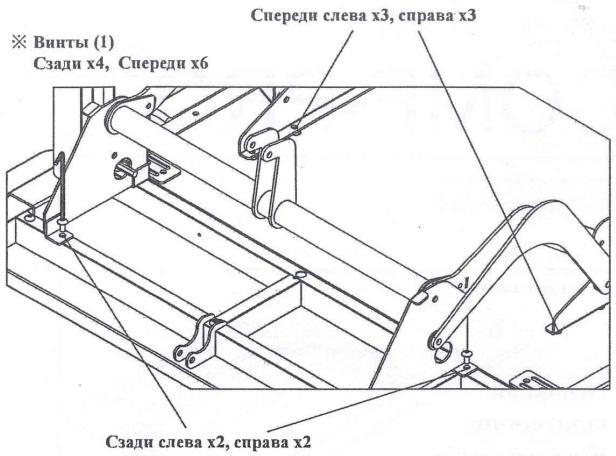
2. Закрепите механизм регулировки (H) на столешницах (A) и (B) с помощью винтов (1) и шестигранника (8)
