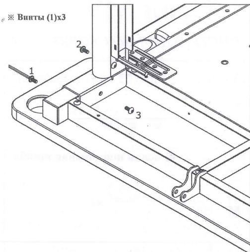
1. С помощью шестигранника (8) и винтов (1) зафиксируйте левую ногу (F) на L-образной столешнице (A), но винты до конца не зажимайте
